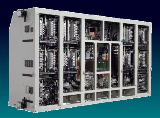
El convertidor de tracción suministra la energía eléctrica a los motores de tracción desde las catenarias de AC o DC.
